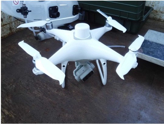
D J I 社製 Phantom 4 機体の中央下にあるものがカメラ
